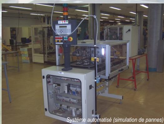
Système automatisé (simulation de pannes)
